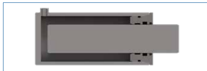
Figura 3.2 Semplice effetto - Fornisce la tenuta con l'aiuto di elementi di tenuta per stelo
