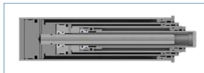
Figura 3.5 Cilindro telescopico a doppio effetto
